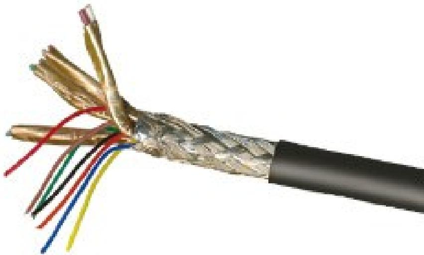
Com a nova versão com Ethernet, houve a necessidade de adicionar 1 par trançado. Assim esses cabos são compostos pelos mesmos 4 pares para o sinal TMDS, 4 cabos para os códigos e sincronismo, mais 1 par que leva o sinal Ethernet e retorno de áudio. Veja na foto abaixo o novo cabo, que apesar de estar decrito como 1.4 equivale ao High Speed com Ethernet.
