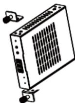
**Step 2:** Insira o produto com as orelhas de montagem em um rack 4U (até 12 unidades podem ser instaladas verticalmente), conforme mostrado na figura abaixo:
